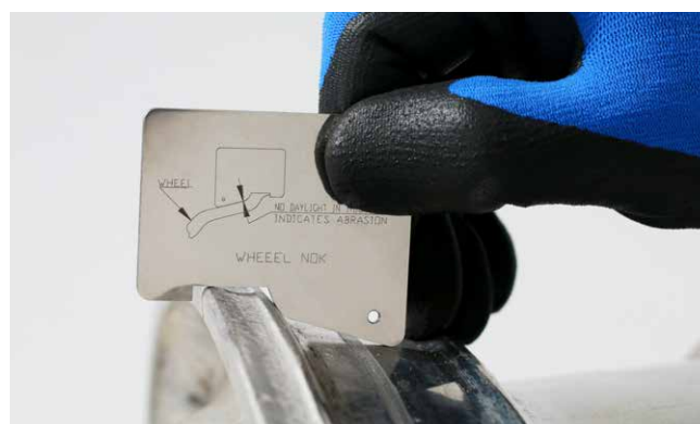
Bild 4: Kontrollmätning efter bearbetningen
