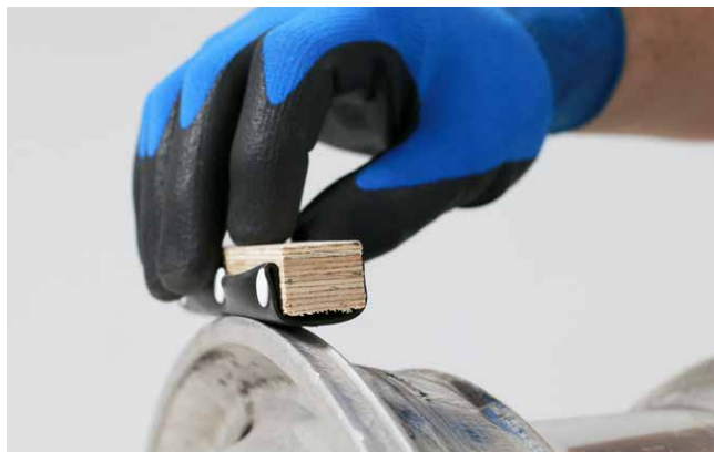
Bild 1: Gummitest av vassa kanter
